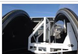
Kuppel für die optische Vertikalsondierung von Methan und Ethan (Foto: Ralf Sussmann, KIT)
